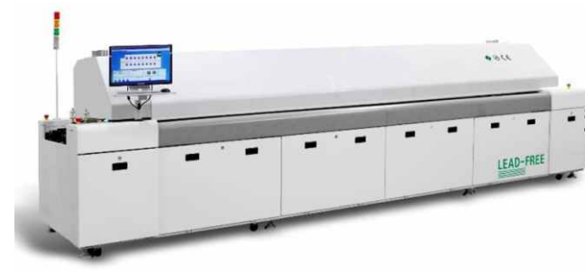
Lò sấy nhiệt tuần hoàn Hot air reflow oven JTU Singapore
